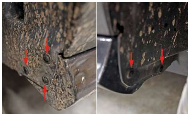
Bild 1: Spreiznieten vorne und hinten entfernen
