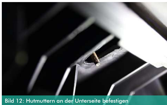
Bild 11: Hutmuttern an der Unterseite befestigen
