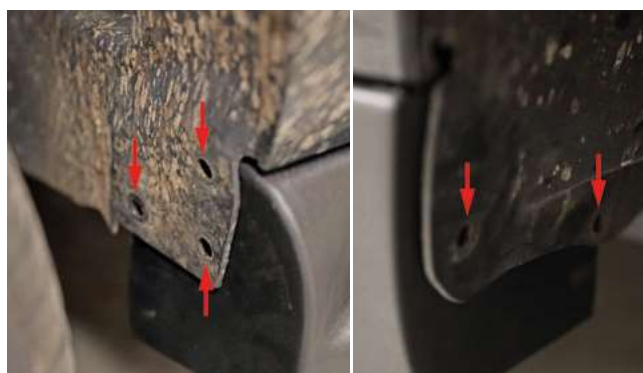
Bild 13: Spreiznieten wieder einsetzen
