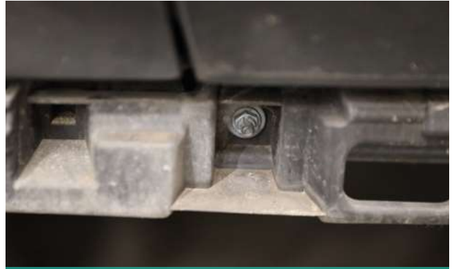
Bild 4: Sechs Muttern vom Grundträger entfernen
