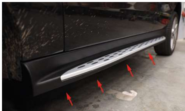
Bild 11: Hutmuttern an der Unterseite befestigen
