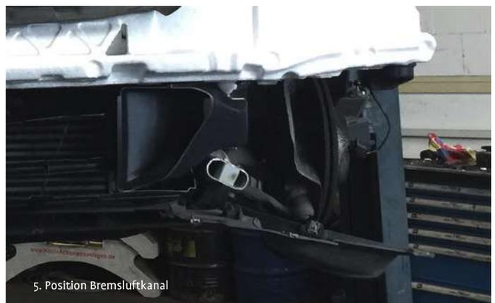
5. Position Bremsluftkanal
