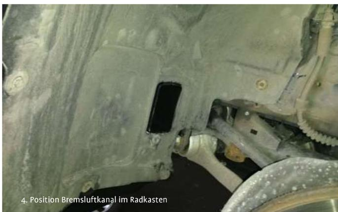
4. Position Bremsluftkanal im Radkasten
